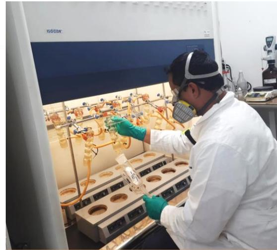
Lectura de muestra por métodos de referencia convencional (secado en horno y soxhlet)
