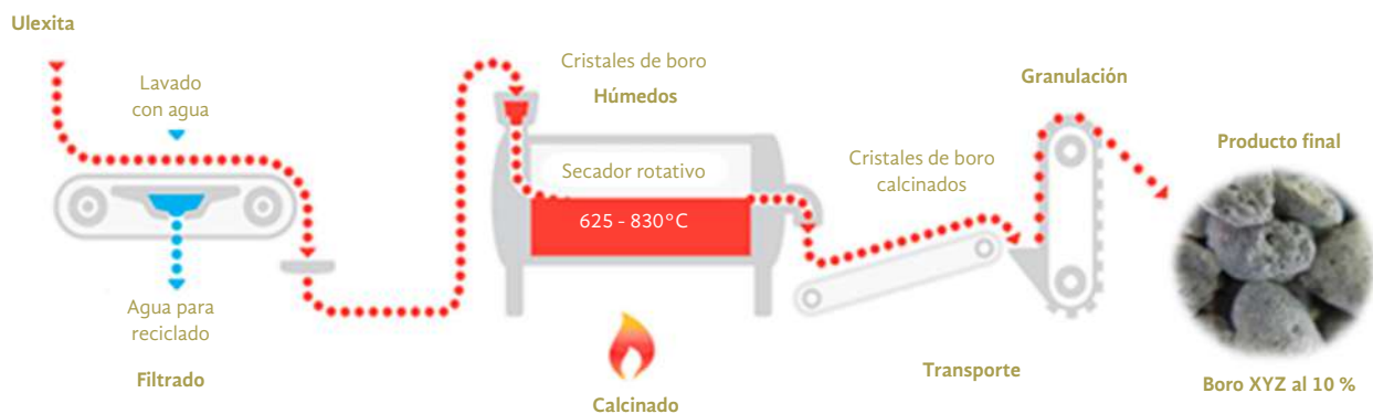
Figura 3. Proceso de beneficio de borato de sodio y calcio.
