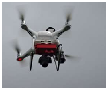
Figura 3. El sensor MicaSense a bordo de un VANT sobre una plantación en Malasia.
