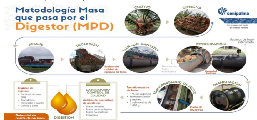
Figura 2. Diagrama de flujo metodología masa que pasa por el digestor MPD-potencial de aceite criterios de calidad de racimos cultivares híbridos OxG. Fuente: Programa de procesamiento Cenipalma.
