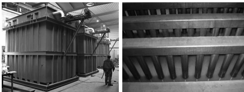
Figura 1. Vista externa e interna (paquetes en movimiento) de una Mobilizer™.
