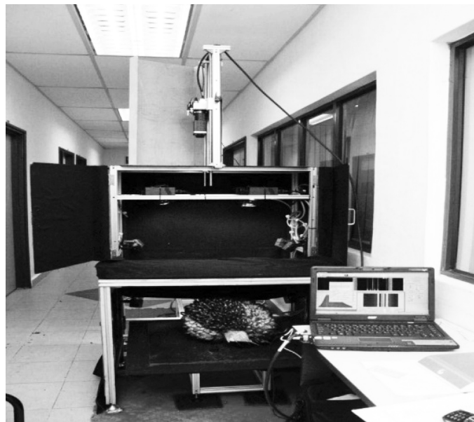
Figura 3. Vista esquemática del sistema de imágenes hiperespectrales con un racimo de fruta fresca en la cinta transportadora. (Tomado de O.M. Bensaeed et al. Clasificación de fruta de palma mediante un dispositivo hiperespectral y algoritmos de aprendizaje automático. Series de Conferencias IOP: Ciencias de la Tierra y Ambientales 20, 2014, 012017).
