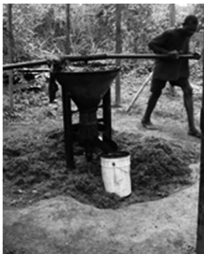
Figura 5. Izquierda: mujeres en la labor de extraer el aceite con prensa manual discontinua de pequeña escala en Costa de Marfil. Derecha: hombres en la labor de extraer el aceite con prensa manual continua de pequeña escala del tipo “Caltech” en Camerún. (Fotos: Sylvain Rafflegeau).
