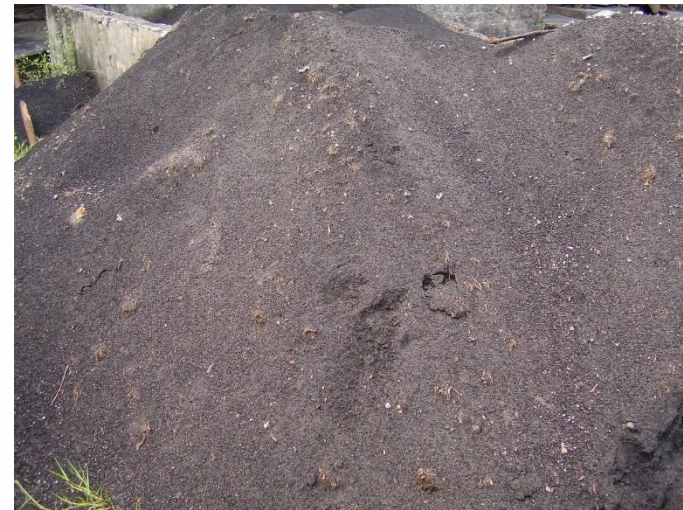
Cenizas de caldera de extracción de aceite de palma
