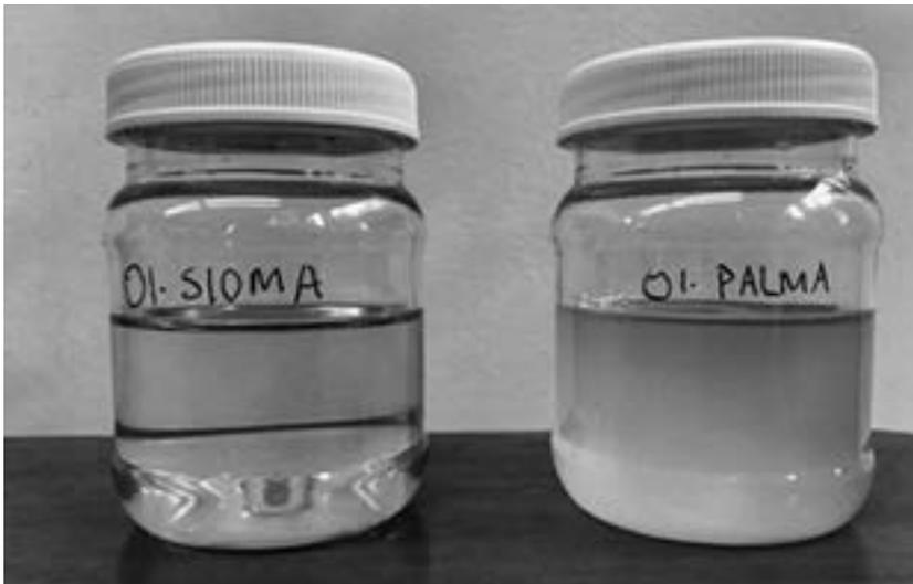
**Figura 3.** Comparación de la oleína Sioma® con oleína de palma, la primera tiene un punto de nube menor.
