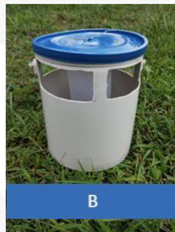
A. Sobre de polietileno de alta densidad B. Recipiente de 4 L con ventanas laterales enterrado en el suelo
