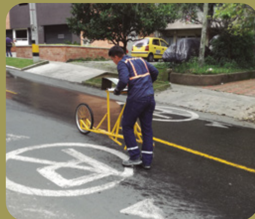
Figura 91. Medición de la regularidad superficial del asfalto
