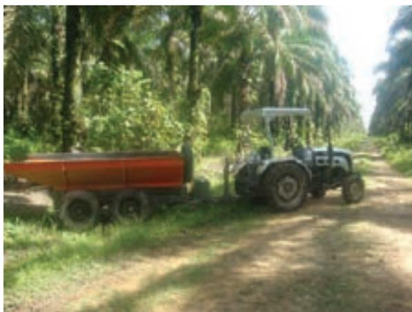
**Figura 9.** Tractor con zorrillo hidráulico.
