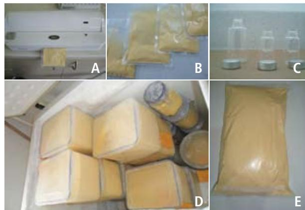
**Figura 4.11.** Ejemplos de empaque del polen. A. Empacadora al vacío. B. Muestras de polen selladas al vacío. C. Ampollas de vidrio con cierre hermético. D. Recipientes plásticos para almacenamiento de polen comercial. E. Presentación de 1 kg de polen empacado al vacío. Fotos: A. Sánchez, E. Daza y G. Rosero, Guaicaramo S.A., 2011.
