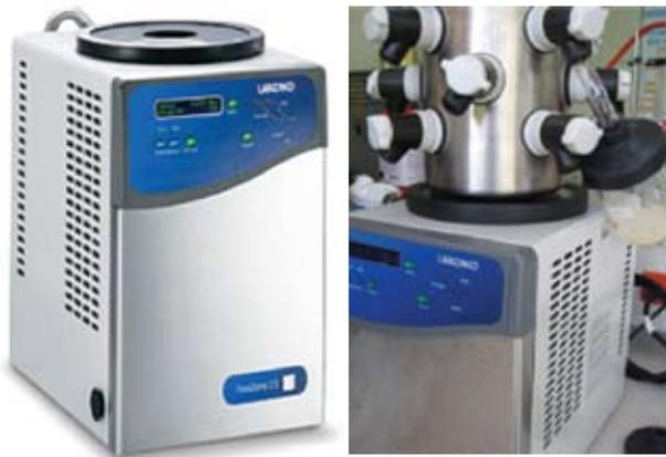
**Figura 4.10.** Sistema de secado al vacío-lioofilizador. Fotos: F. Prada, 2011.
