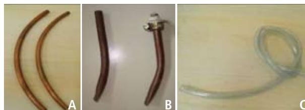
**Figura 2.10.** Canal de salida en el equipo de polinización. A. Tubo de cobre para frasco de aluminio. B. Tubo de cobre para frasco de salsas. C. Manguera plástica para tarro de aluminio. Fotos: A. Sánchez, 2011.
